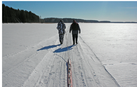
Пешая георадиолокационная съёмка радаром «Тритон» 50 МГц (берег о-ва Силон, Дарвинский заповедник)
