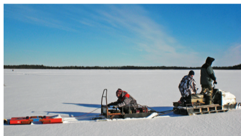
Георадиолокационная съёмка радаром 150 МГц в сцепке со снегоходом (оз. Белое, Бабаевский район)
